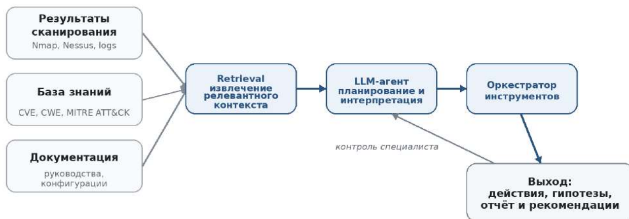
Рис. 3. Обобщённая логика мультиагентной RAG-системы в тестировании на проникновение
