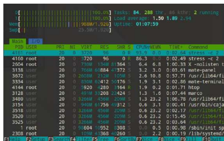
Рис. 5. htop при cpuset="0-1" : оба ядра загружены равномерно
