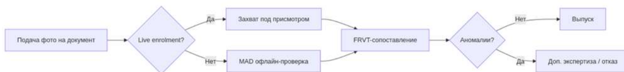
Рис. 6. Процессная схема противодействия морфингу и дипфейкам при регистрации и проверке
