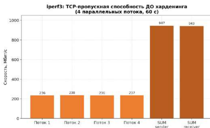
Рис. 15. Iperf3: TCP-пропускная способность до харденинга
