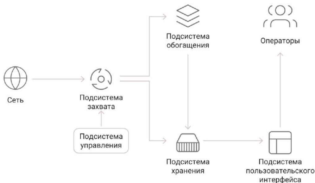
Рис. 1. Технологическая схема обработки сетевого трафика в РТ NAD (по материалам [34])
