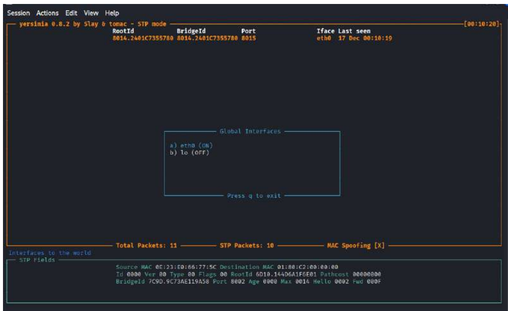
Рис. 2 Интерфейс утилиты Yersinia, используемой для формирования кадров с двойным тегированием 802.1Q
