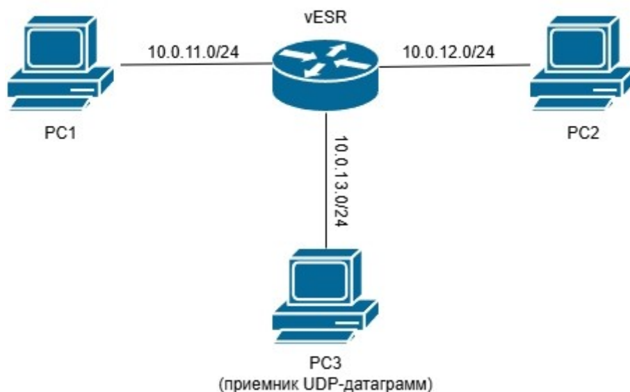
Рис. 1. Схема лабораторного стенда: PC1 и PC2 — источники трафика, vESR — маршрутизатор и агент sFlow, PC3 — приёмник UDP-датаграмм
